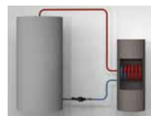
■ Puffer und Boiler getrennt
